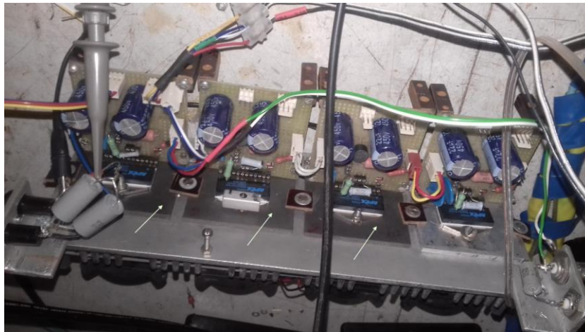
Рис. 4. Широкосмуговий високовольтний підсилювач з віртуальним живленням складається з чотирьох операційних підсилювачів, три з яких (ліворуч) розміщені на керамічних пластинах з AlN, які відмічені білими стрілками
